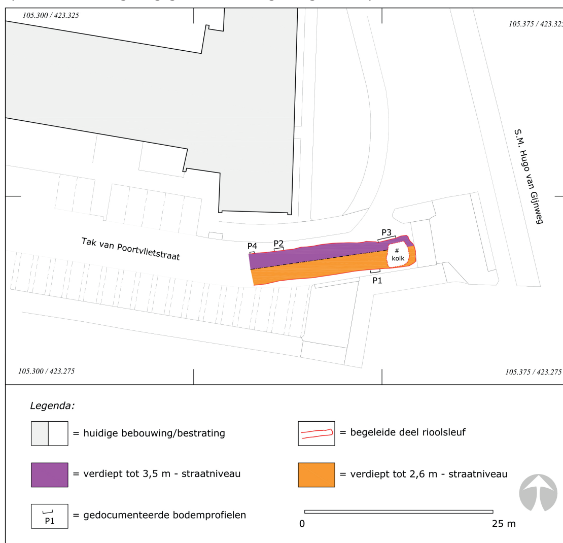
Afb. 16. Een overzicht van de ligging van het begeleide deel van de riolsleuf in de Tak van Poortvlietstraat met daarin aangegeven de ontgravingsdieptes per deel en de vier gedocumenteerde bodemprofielen (P1-P4, Dorst 2024, vakteam erfgoed).
