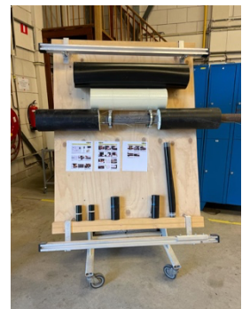
Proefopstelling warmtenet bij De Beroepentuin >
