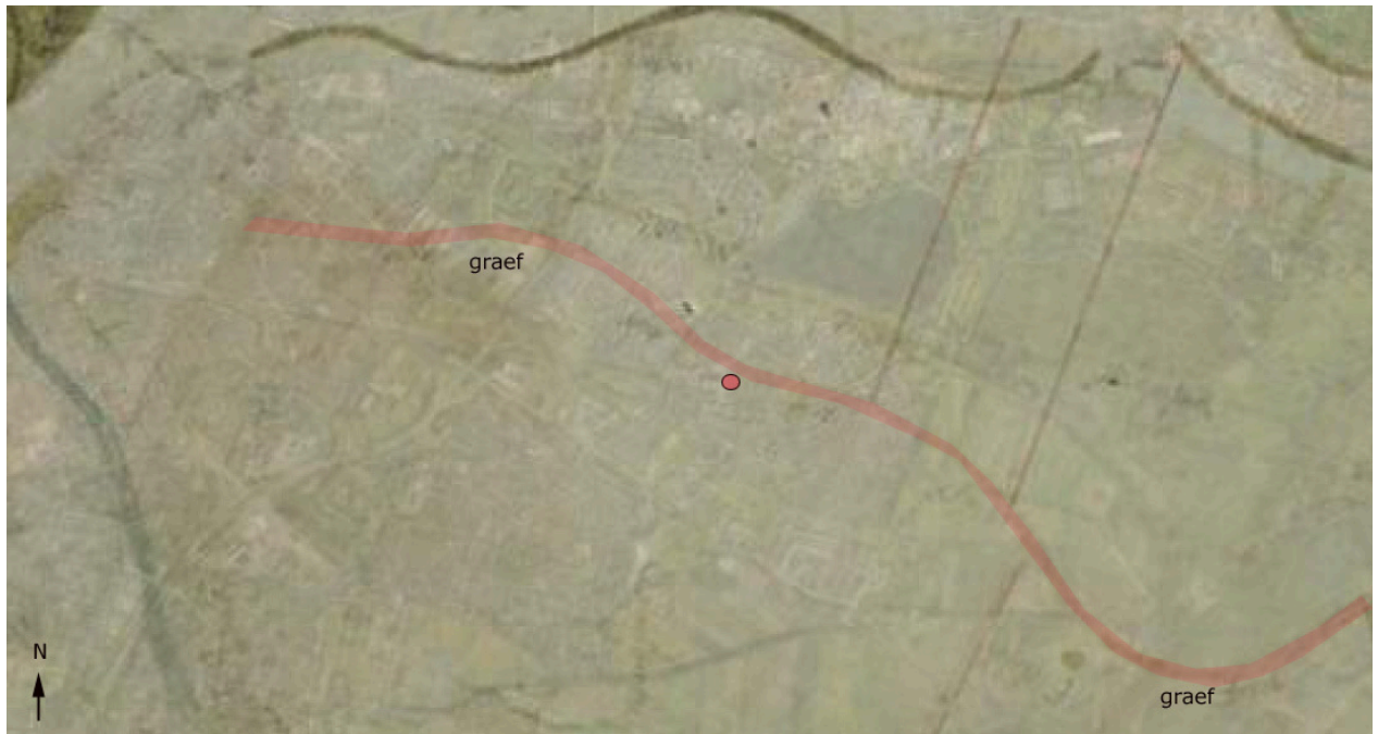
Afb. 3. Een kaart van vóór 1560 geplot op de huidige topografische kaart (Nationaal Archief, collectie Hingman, inventarisnr. 1893). Plot door dhr. L. Rietveld op basis van 16e -eeuwse meetgegevens van bolbakens.
