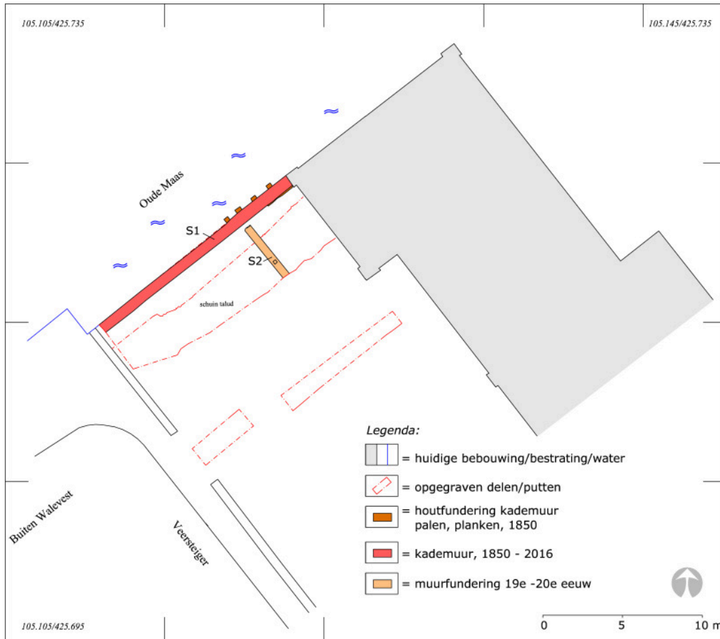
Afb. 23. De sporen uit de derde fase: een nieuwe kademuur en onbekende fundering.
