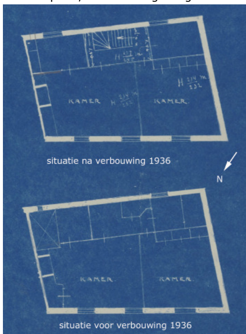
Afb. 6. Eerste verdieping van Kuipershaven 11 in het bouwbestek uit 1936, met daarbij de situatie vóór en ná de verbouwing (RAD archiefnr. 12423).
