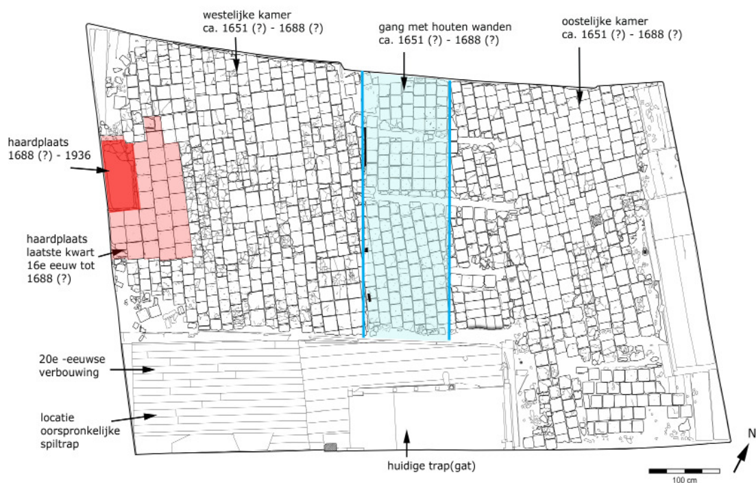
Afb. 11. De 16 e -eeuwse plavuizenvloer met daarin aangegeven de 17 e -eeuwse aanpassingen en onderverdeling tijdens de tweede gebruiksfase (Digitale documentatie, bewerking en afbeelding: Nipides 2015).
