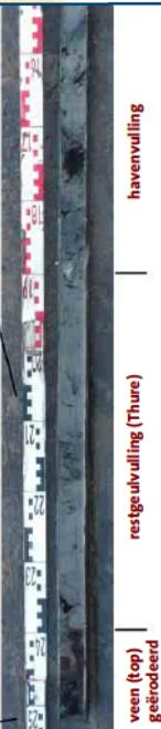
**De overgang van de basis van de havenvulling naar de restgeulafzettingen van de Thure, ingesneden in het veen (rechts); detail van de overgang (links).**
