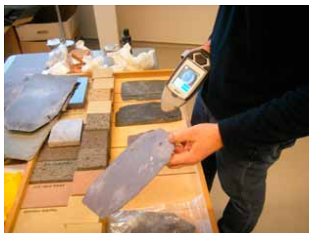
Afb. 56. Het scannen van de dakleien voor de XRF-analyse.
