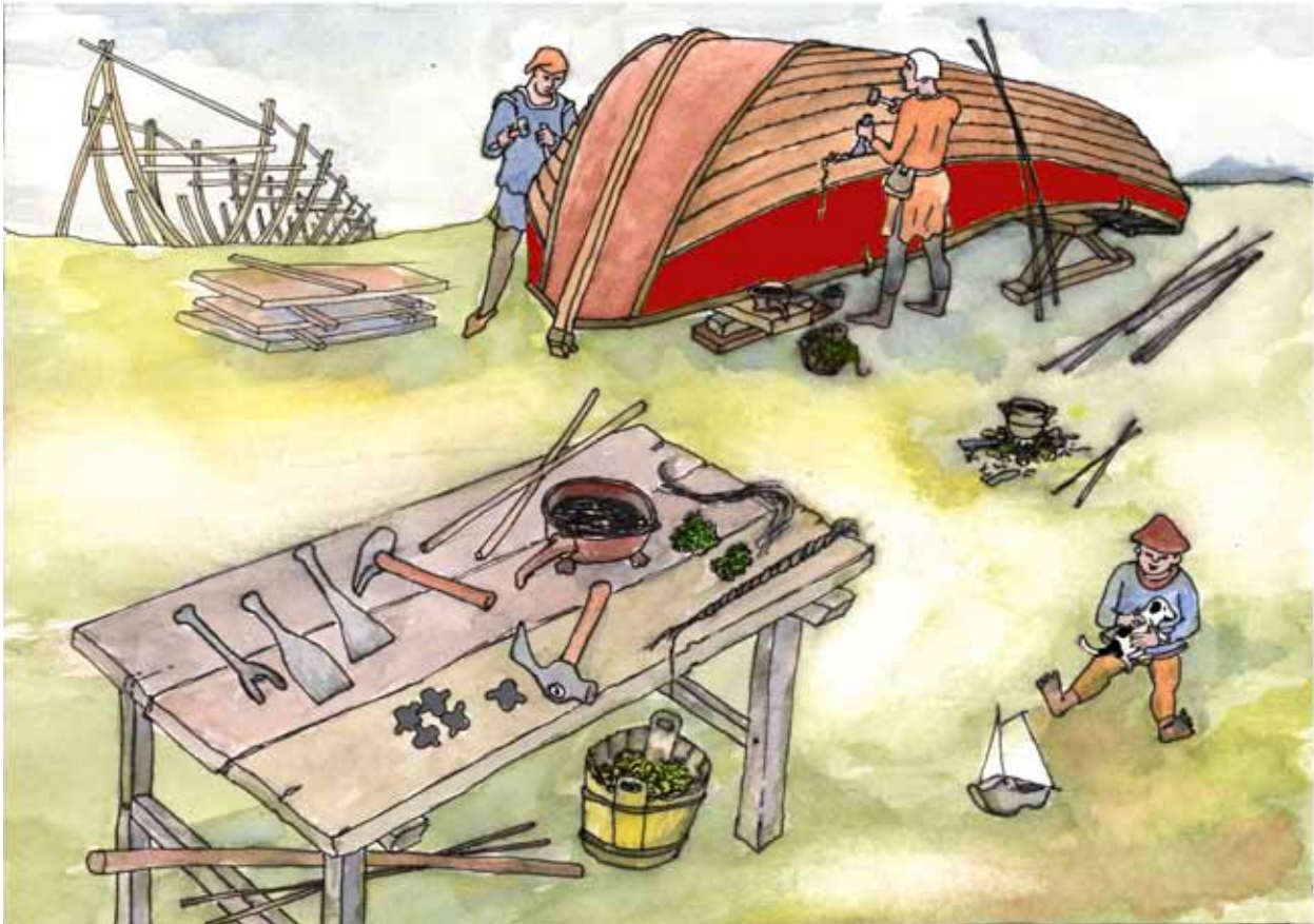
Afb. 233. Het breeuwen van een schip met behulp van sintels (tekening: Olaf Goubitz).
