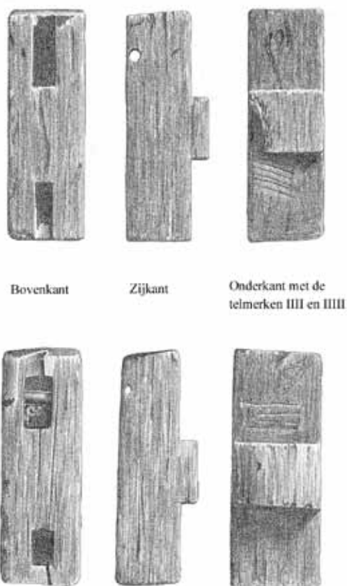
Afb. 51. Tekening van twee blokkelen van het kerkdak. Aan de onderzijde zijn de telmerken IIII en IIIII ingekerfd.
