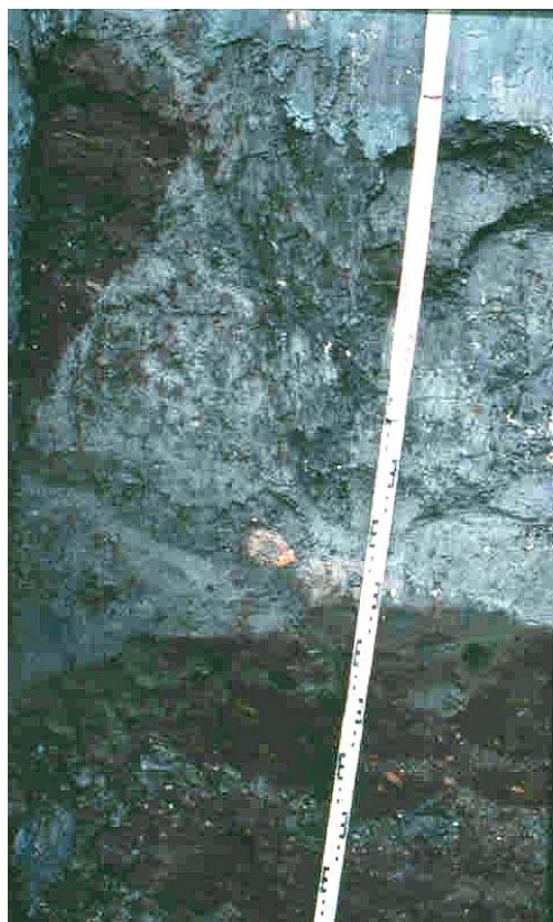
Foto 23. Close up van de eerste dieptewaarneming tot op het natuurlijk veen. Links boven is een grote brok zwevend veen te zien. Deze zorgde voor een in eerste instantie foutieve meting van de diepte waarop het natuurlijk veen begon.
