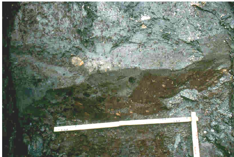
Foto 10. Close up van een dieptewaarneming. Te zien is 'zwevend' veen en stukjes puin in vuile klei.
