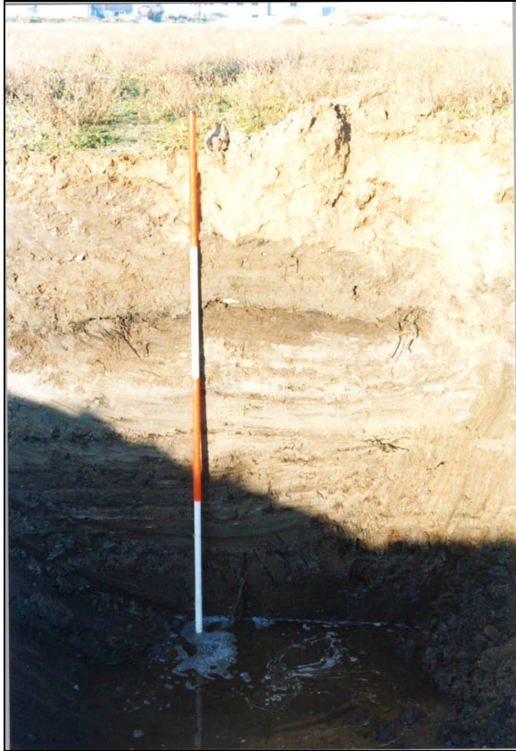
Foto 1: dwarsprofiel PS1, kanaalzijde. Ca. 5 cm. half verteerde riet/plantenstengels. Dun bandje zoetwaterslakjes/schelpjes.
