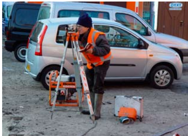
Afb. 16. Meetapparatuur: het waterpasinstrument.
