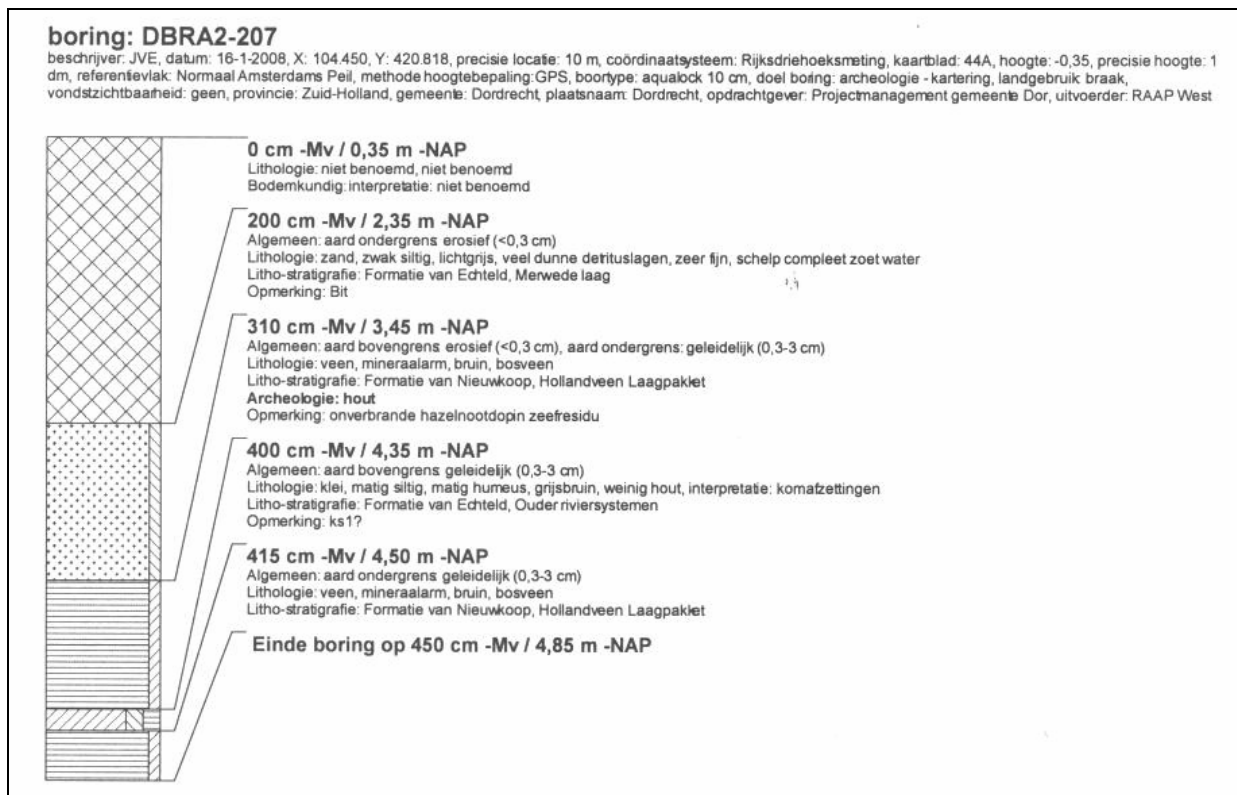
Afb. 2. Geologisch bodemprofiel op basis van boring 207, direct nabij de locatie bolbaken 11 (De Boer 2007).
